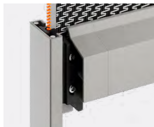
Hohe Windstabilität durch kontrollierte seitliche Gewebeführung mit Reißverschluss über die gesamte Elementhöhe. Max. Fläche 12,25 m 2
