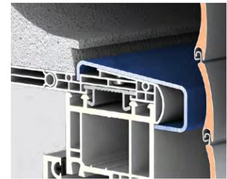
Beispiel Kastenanbindung bei KARO mit Bodenbrettverstärkung (bei KARO ab 2 m Breite Standard)
