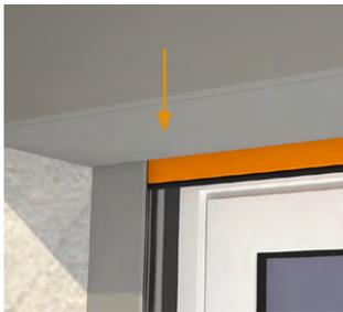
Durch die Entlastungsfahrt bei Drehmomentabschaltung, kann je nach System, Profil und Elementhöhe der Behang bis zu 25 mm aus dem Kasten ragen (orangefarben dargestellt). Dies ist zu berücksichtigen, z.B. beim Aufbau von nach außen öffnenden Insektenschutzrahmen oder Türen etc.
