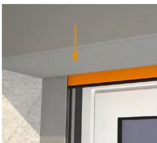
Durch die Entlastungsfahrt bei Drehmomentabschaltung, kann je nach System, Profil und Elementhöhe der Behang bis zu 25 mm aus dem Kasten ragen (orangefarben dargestellt). Dies ist zu berücksichtigen, z.B. beim Aufmaß von nach außen öffnenden Insektenschutzrahmen oder Türen etc.
